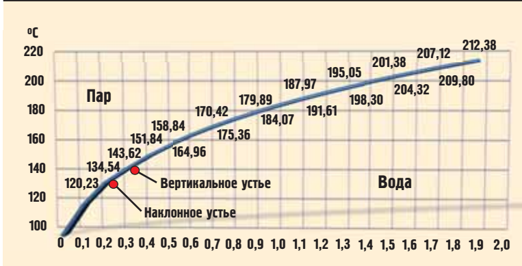
Кривая насыщенного пара с нанесенными термодинамическими условиями на приеме насоса
