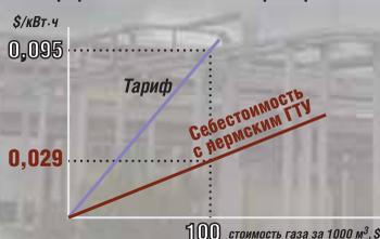
Каждый мегаватт установленной электрической мощности ГТУ-ТЭЦ пермского производства экономит 1,15 миллиона м³ газа в год
