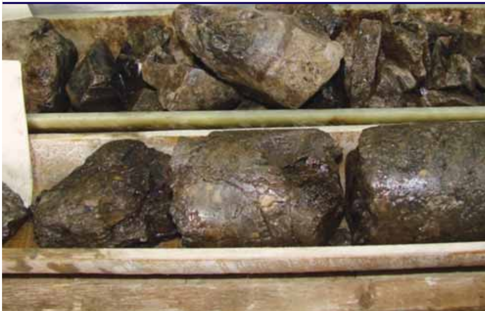
Отбор данного керна производился в стальную (многоразовую) грунтоноску с последующим извлечением на буровой и укладкой в керновые ящики. В таком виде был доставлен в лабораторию на исследование.
