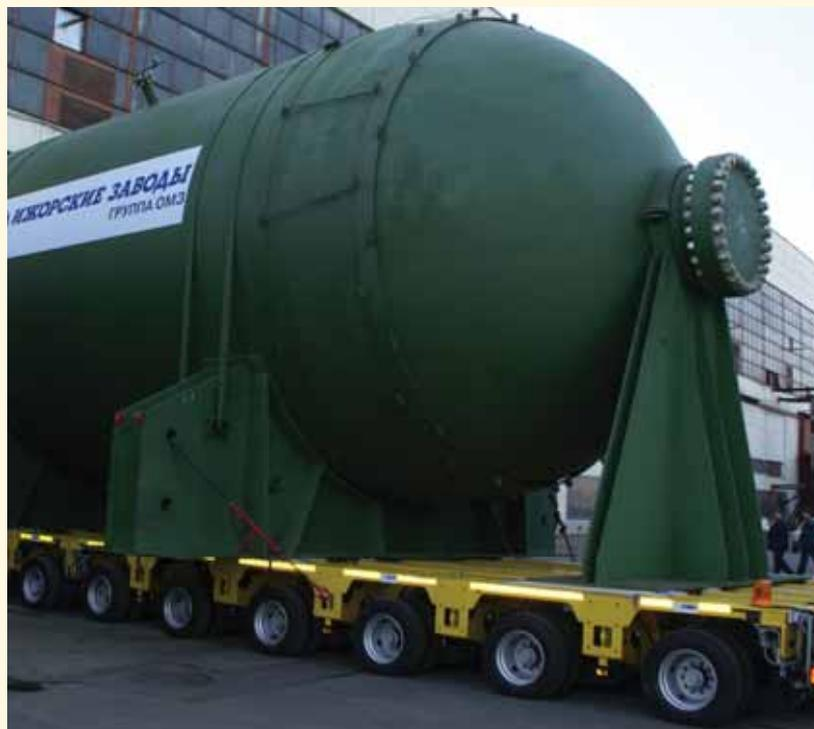
В 2010 году Ижорские заводы отгрузили два реактора гидрокрекинга, изготовленные по заказу ОАО «ТАНЕКО» для строящегося комплекса нефтеперерабатывающих заводов в городе Нижнекамск (Республика Татарстан). Реакторы гидрокрекинга представляют собой уникальные изделия: диаметр — более 5 метров, длина — 35 метров, толщина стенки сосуда составляет 295 мм. Вес каждого реактора — более 1200 тонн.
