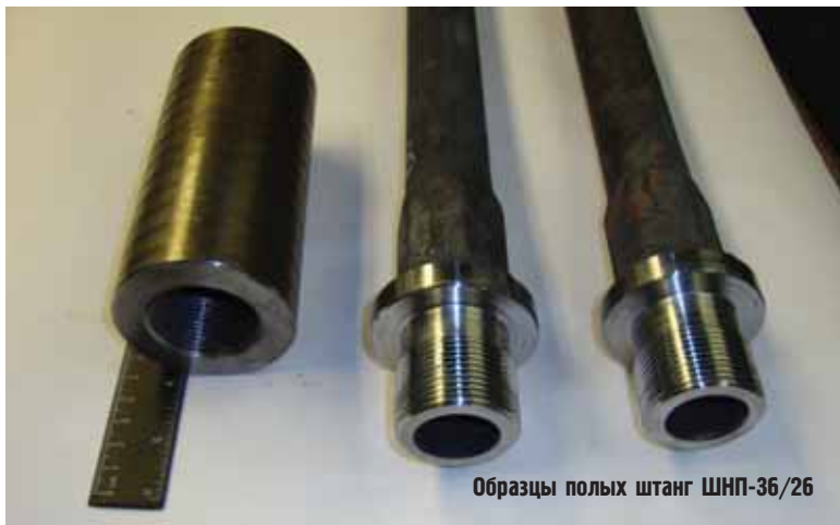
Образец полых штанги после разрыва усилием 45 тонн
