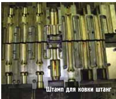
Ковка насосных штанг на ковочном комплексе Etchells
