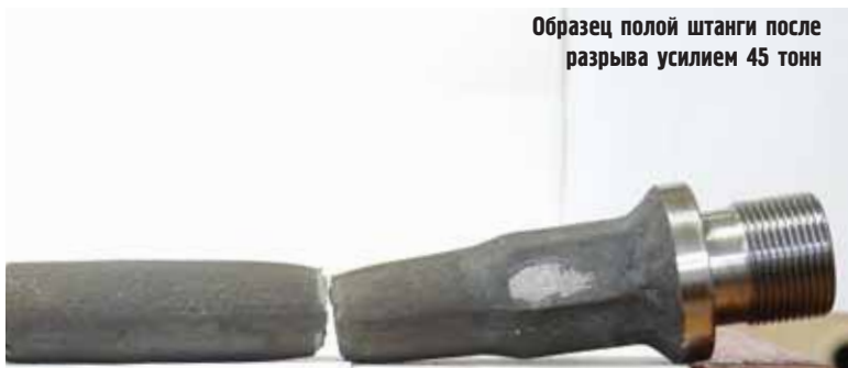
Образцы полых штанг ШНП-36/26
