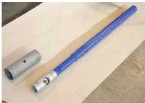
Данный инструмент позволяет производить пробивку отверстия в колонне НКТ типоразмера 60 и 73 мм с толщиной стенки 5,0 и 5,5 мм соответственно. Отверстие выполняется без применения взрывчатых веществ и не сопровождается повреждением обсадной колонны и цементного кольца; как правило, инструмент используется силами самой бригады подземного ремонта.
