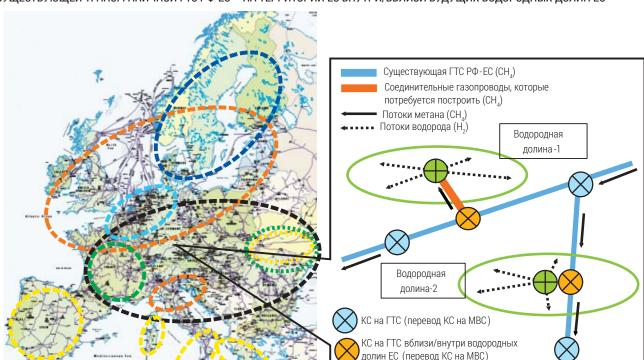
ПРИМЕРНАЯ ПРЕДЛАГАЕМАЯ СХЕМА РАЗМЕЩЕНИЯ ПРОИЗВОДСТВА ЧИСТОГО ВОДОРОДА ИЗ ПРИРОДНОГО ГАЗА НА ОСНОВЕ СУЩЕСТВУЮЩЕЙ ТРАНСГРАНИЧНОЙ ГТС РФ-ЕС – НА ТЕРРИТОРИИ ЕС ВНУТРИ/ВБЛИЗИ БУДУЩИХ ВОДОРОДНЫХ ДОЛИН ЕС
