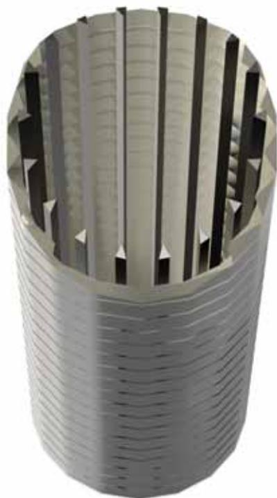
**Н**ефтяникам нет нужды объяснять, для чего служит скважинный фильтр — он предназначен для фильтрации добываемого продукта от посторонних включений, выноса песка и попадания в скважину механических примесей при эксплуатации. Скважинный фильтр устанавливается в продуктивном пласте скважины и предотвращает разрушение призабойной зоны и слабоцементированных коллекторов.
