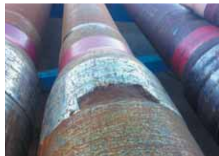
ИЗНОС ОБСАДНОЙ ТРУБЫ В %, ТЕСТ МОНР
