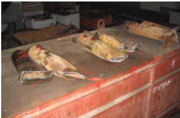
Труба 140x9, перерезанная при испытаниях перерезывающего превентора ППС-350x35
