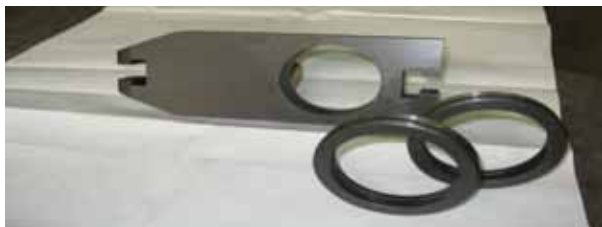
Шиббер задвижки и седла с азотированной рабочей поверхностью до HV 800-1050 ед.
