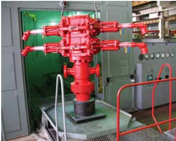
Комплекс технологического оборудования для испытаний ПВО на функционирование (прочность, герметичность)
