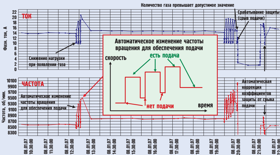
Применение нового алгоритма позволяет избежать срабатывания защиты от срыва подачи по газу, если это в принципе возможно
