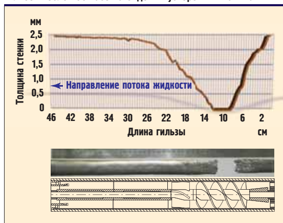
Рис.4 Износ винтовой гильзы газосепаратора после 100 часов стендовых ускоренных испытаний
