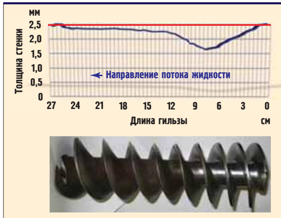
Рис.5 Износ гильзы и сепарационного шнека геликоидального газосепаратора после 100 часов стендовых ускоренных испытаний
