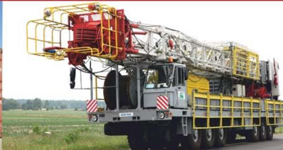
Многоосные полноприводные шасси VOLAT повышенной проходимости и грузоподъемности – надежная проверенная опытом эксплуатации колесная база для монтажа различных установок, задействованных при проведении разведки, бурения, ремонта и сервисных работ в нефтегазовой отрасли: мобильные буровые установки, колтюбинговое оборудование, компрессорные, цементировочные установки, азотные станции, оборудование для выполнения геологоразведочных работ и пр.
