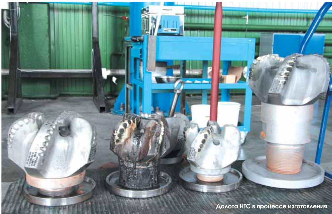
Долота НТС в процессе изготовления
