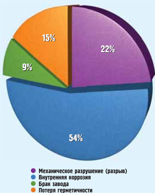
Рис.1 Причины выхода из строя электроизолирующих соединений нефтепромысловых трубопроводов на примере крупной нефтяной компании
