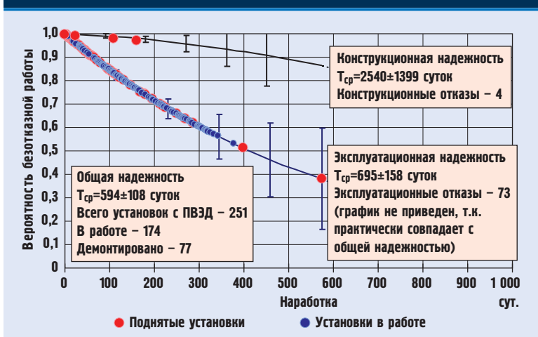
Рис.3. Общая и эксплуатационная надежность УЭЦН и конструкционная — вентильных двигателей
