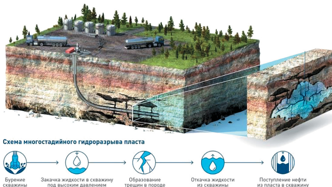
Рис. 8. Многостадийный гидроразрыв пласта
