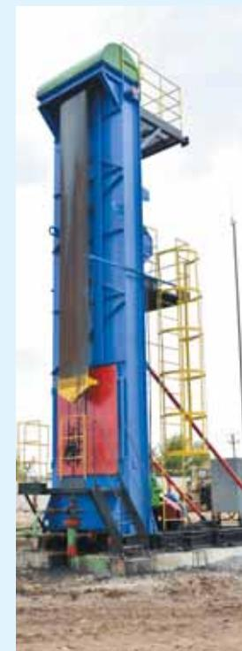
Привод цепной (ПЦ 30 — ПЦ 120) скважинного штангового насоса с постоянной длиной хода точки подвеса штанг от 3–8 м и регулируемым числом качаний до 4 раз в минуту, грузоподъемность от 3–12 т.
