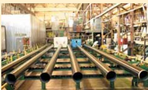
Стальные трубы диаметром 57–426 мм с внутренним полимерным покрытием и наружной полиэтиленовой изоляцией. Внутренне покрытие и способ соединения обеспечивают равнопроходное сечение по всему трубопроводу, уменьшают гидравлические потери на транспортирование сред, отложения парафинов и солей в трубопроводе. Температура транспортируемой среды до +160°С.
