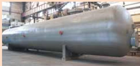
Емкостные аппараты для жидких сред, газа и воздуха, изготавливаются объемом 200 м<sup>3</sup>, давлением до 16 МПа, массой до 80 т. Предназначены для применения в технологических установках нефтеперерабатывающей, нефтехимической, химической, нефтяной, газовой и других отраслей промышленности.
