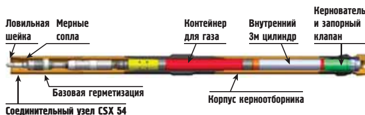
СХЕМА КЕРНОВОГО БУРОВОГО УСТРОЙСТВА QUICKCAPTURE
