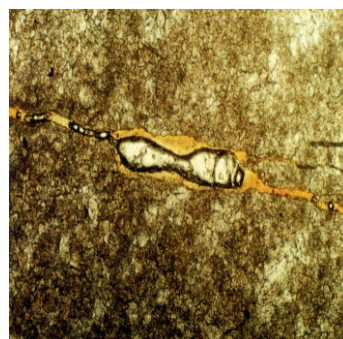
Диаклазовый тип коллектора. Сква.Юрубченская-39 Глубина 2428,6 м. Шлиф, николи II. Ктр=4,6 мдарси; мтр=0,05% Трещина заполнена нефтью (желтый цвет)
