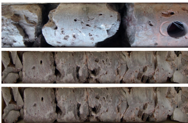
Каверновый тип коллектора. Фрагмент керна рифейских отложений по скв. Платоновской-1 (инт. 2876-2896 м)
