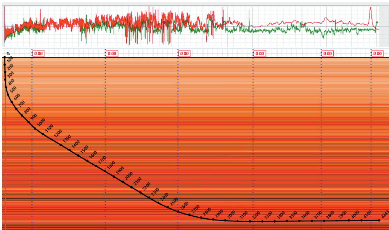
Рис. 2. Модель геонавигации в режиме редактирования. Синими вертикальными линиями указаны границы секций, с помощью которых происходит изменение модели
