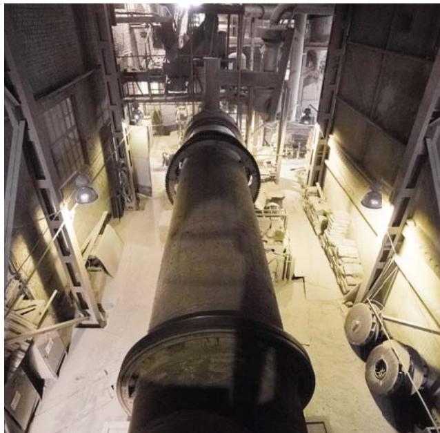
Технологическая линия по сушке и помолу бентонита (сушильный барабан)
