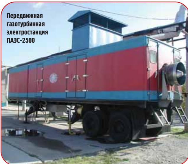
Опыт эксплуатации ПАЭС-2500 на малокалорийном шахтном метане способствовал разработке универсального газотурбинного энергетического комплекса внешнего сгорания ГТЭУВС-2,5МС, который способен работать на различных видах топлива от 1000 до 10000 Ккал/м<sup>3</sup>.
