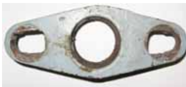
Фото 9. Фланец сальника (отверстия под шпильки имеют неправильную форму)
