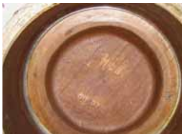
Фото 9. Фланец сальника (отверстия под шпильки имеют неправильную форму)
