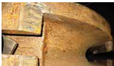
Фото 7. Трещина «пузовины» корпуса, соединяющая уплотнительные седла
