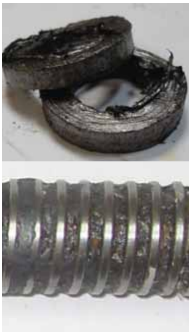
Фото 1. Набивка сальника и шпindel со следами набивки в резьбе
