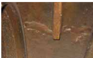
Фото 7. Трещина «пузовины» корпуса, соединяющая уплотнительные седла
