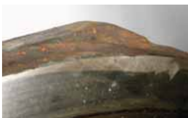
Фото 10. Уплотнительная поверхность клина (зачищена шлифовальной машинкой)
