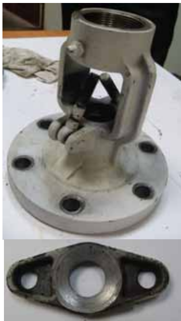
Фото 2. Стойка с откидными болтами и фланец сальника
