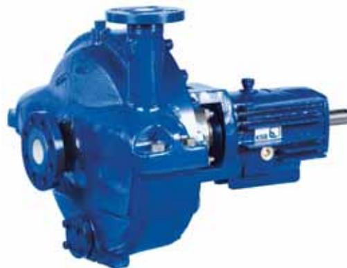
Уплотняющая камера в соответствии с API 610 позволяет применять любые типы торцовых уплотнений по API 682, а зазор направляющей втулки вала выполнен в соответствии с API 610.
