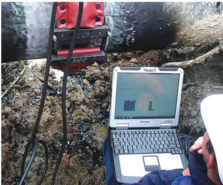
Обследование трубопроводов методом направленных волн WAVEMAKER G3
