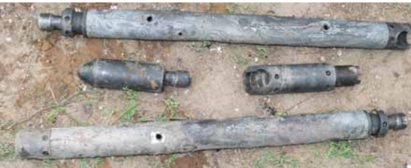
Рис.10 Разборка ПС SNAKE после отстрела
