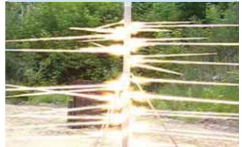
Рис.7 Момент срабатывания ПС SNAKE в обсадной колонне
