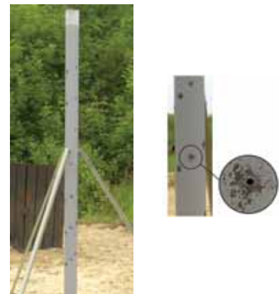
Рис.8 Обсадная колонна после отстрела
