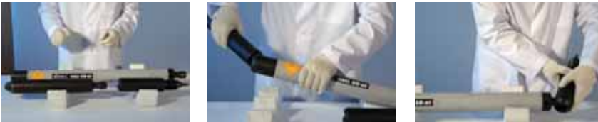
Рис.10 Разборка ПС SNAKE после отстрела
