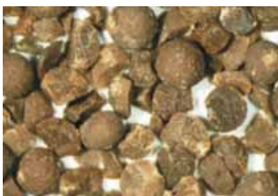
Проба после сжатия при 6000 psi, замачивания в нефти и после обжига при 800°C
