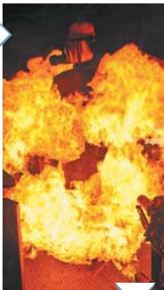
ГК «Энергоконтракт» проводит испытания на воздействие открытого пламени на установке Thermo-Man (ISO 13506). В течение 4 секунд защитный комплект подвергается воздействию открытого пламени из 12 газовых горелок. Более 100 датчиков фиксируют изменение температуры под одеждой на протяжении одной минуты, что позволяет оценить и так называемый «остаточный» ожог. Именно он, а не само воздействие пламени, часто становится фатальным.
