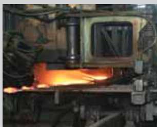
Ковка насосных штанг на ковочном комплексе Etchells
