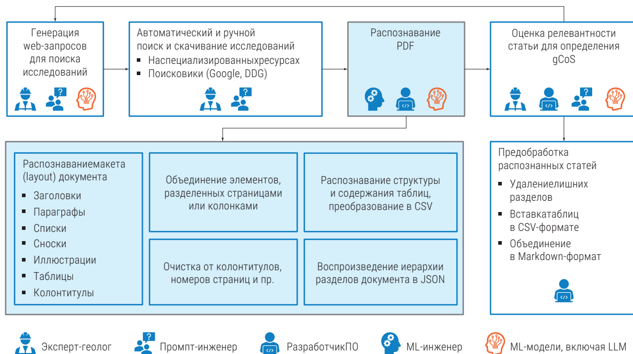
Рис. 3. Методологическая схема поиска и препроцессинга неструктурированных данных геологических отчетов
