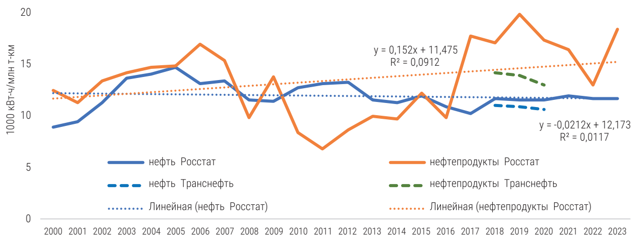
Рис. 11. Динамика удельного расхода энергии на транспорт нефти и нефтепродуктов
