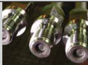
Дробеструйная обработка штанг (для удаления окалины и повышения прочности штанг)
