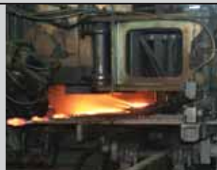
Ковка насосных штанг на ковочном комплексе Etchells
