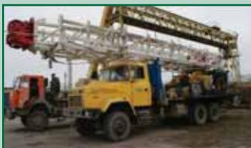
Агрегат УПА-60/80 предназначен для текущего ремонта, освоения и капитального ремонта нефтяных и газовых скважин, а также ведения буровых работ роторным способом или забойными двигателями (при соответствующей комплектации) на скважинах различного назначения: поисковых, гидрогеологических, водозаборных, эксплуатационных (нефтяных, газовых) в районах с умеренным и холодным климатом при температуре окружающего воздуха от  $-45^{\circ}\text{C}$  до  $+45^{\circ}\text{C}$ .
