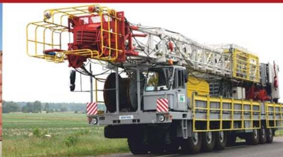
Многоосные полноприводные шасси VOLAT повышенной проходимости и грузоподъемности – надежная проверенная опытом эксплуатации колесная база для монтажа различных установок, задействованных при проведении разведки, бурения, ремонта и сервисных работ в нефтегазовой отрасли: мобильные буровые установки, колтюбинговое оборудование, компрессорные, цементировочные установки, азотные станции, оборудование для выполнения геологоразведочных работ и пр.
