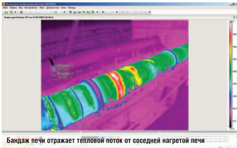
**Бандаж печи отражает тепловой поток от соседней нагретой печи**
