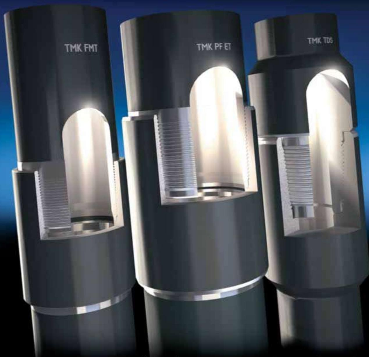
Насосно-компрессорные трубы с высокогерметичным резьбовым соединением TMK FMT для газовых и нефтяных скважин с высоким газовым фактором и работы в H<sub>2</sub>S и CO<sub>2</sub> среде.
