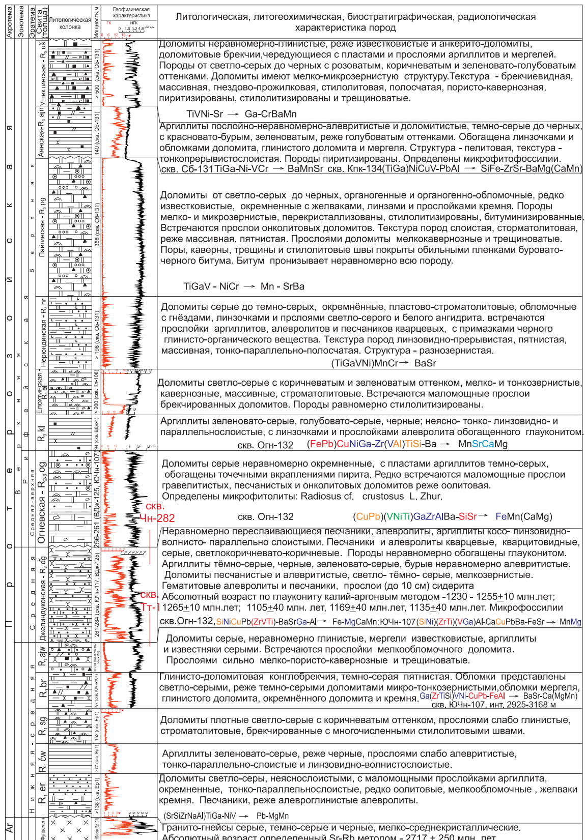
Рис. 10. Сводный разрез рифейских отложений Катангского фациального района с положением скв. Тэтэрской-1 и Чункинской-282 (составлен Гутиной О.В., 2003, 2007, по материалам Кренцлера Б.Б.). Условные обозначения см. рис. 13
