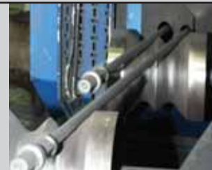
Дробеструйная обработка штанг (для удаления окалины и повышения прочности штанг)
