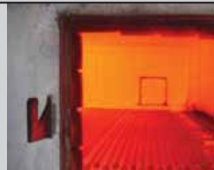
Заготовки штанг в печи (для создания однородной структуры металла штанги)
