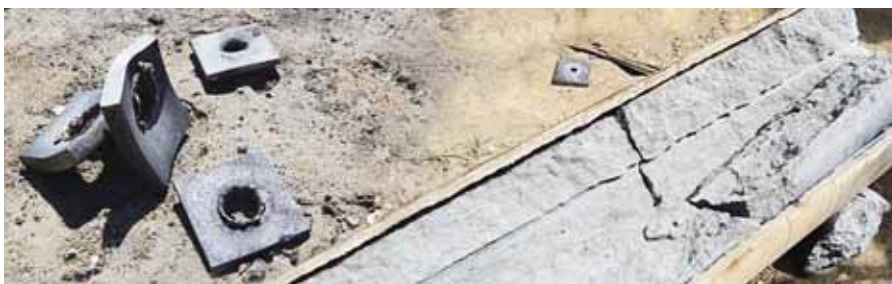
Пластины и имитатор обсадной колонны после отстрела ЗПК 89-АТ-М-10 Т
