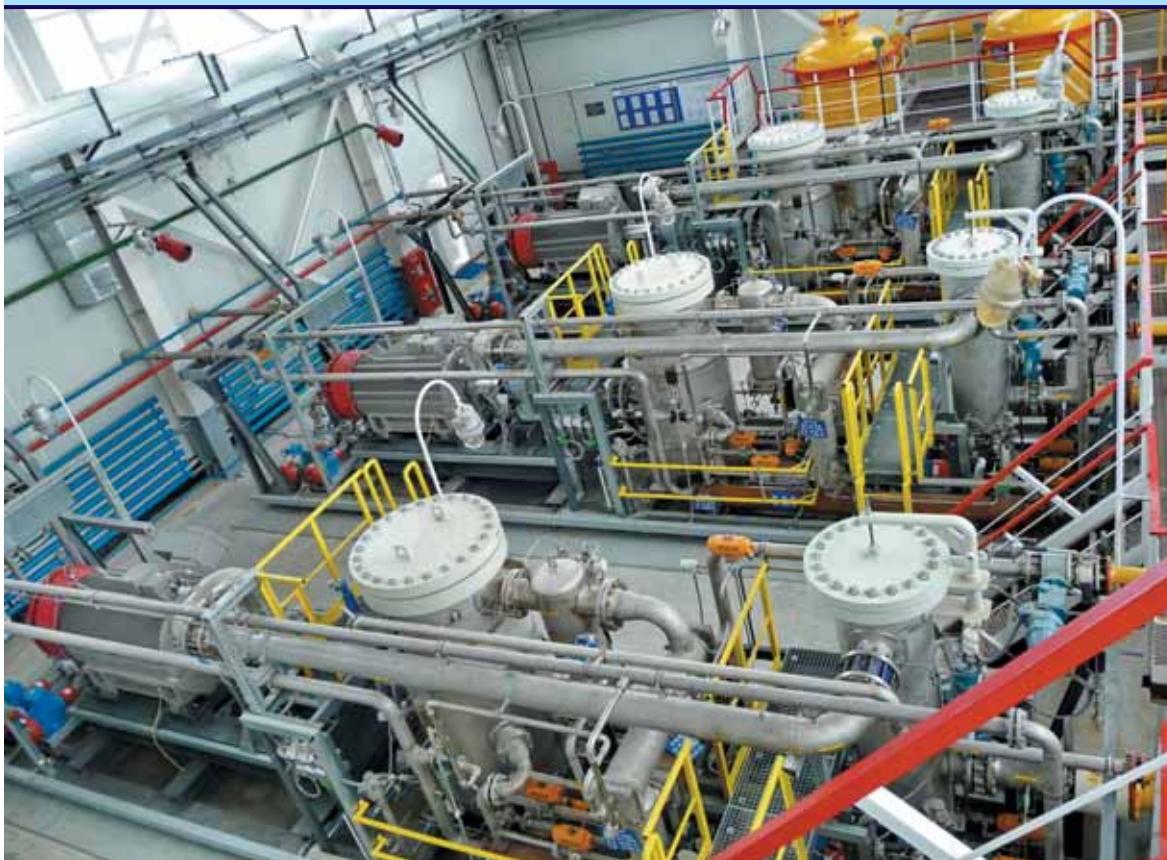
Фото 6. УПТГ на открытой раме для ГТЭС Талаканского месторождения
