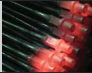
Заготовки штанг после ковки
