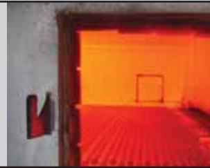
Заготовки штанг в печи (для создания однородной структуры металла штанги)
