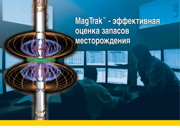
Каротаж во время бурения MagTrak™ позволяет определить общую и эффективную пористость, содержание свободного и связанного флюида, а также коэффициент проницаемости посредством регулярных и точных магнитно-резонансных измерений.
