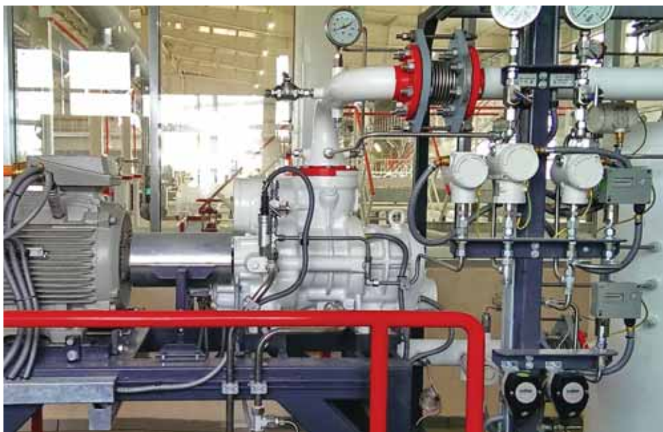
Фото 8. Компрессорная установка-симулятор для учебного центра ОАО «Сургутнефтегаз»
