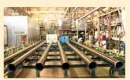
Стальные трубы диаметром 57—426 мм с внутренним полимерным покрытием и наружной полиэтиленовой изоляцией. Внутренне покрытие и способ соединения обеспечивают равнопроходное сечение по всему трубопроводу, уменьшают гидравлические потери на транспортирование сред, отложения парафинов и солей в трубопроводе. Температура транспортируемой среды до +160°C.
