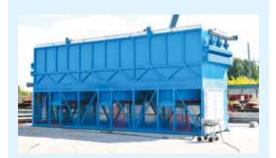
Аппараты весом до 30 т, работающие под давлением до 320 атм., предназначены для охлаждения и конденсации парообразных, газообразных и жидких сред в технологических процессах нефтеперерабатывающей, нефтехимической и смежных отраслях промышленности.
