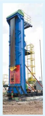
Привод цепной (ПЦ 30 — ПЦ 120) скважинного штангового насоса с постоянной длиной хода точки подвеса штанг от 3—8 м и регулируемым числом качаний до 4 раз в минуту, грузоподъемность от 3—12 т.
