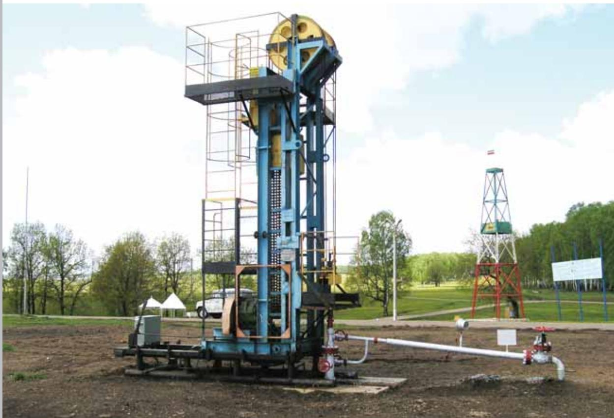
В ОАО «Татнефть» создан параметрический ряд цепных приводов с длинами ходов от 2,1 до 7,3 метра грузоподъемностью от 40 до 120 кН. Серийное производство цепных приводов освоено Бугульминским механическим заводом.
