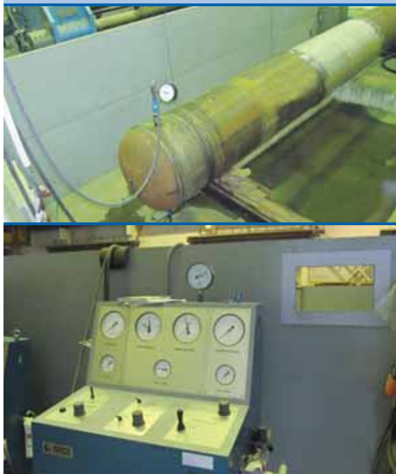
РИС.5 ГИДРОИСПЫТАНИЯ КАТУШКИ ОПОРЫ НЕПОДВИЖНОЙ
