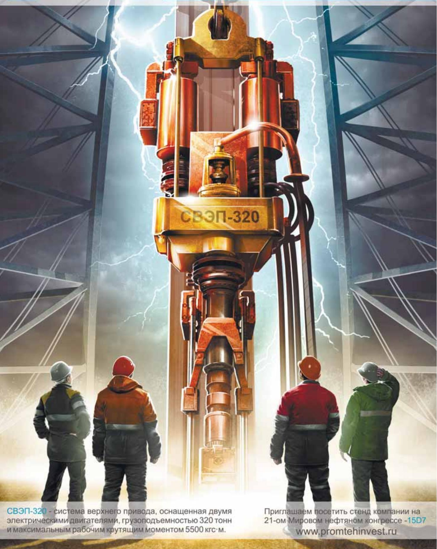
**СВЭП-320** - система верхнего привода, оснащенная двумя электрическими двигателями, грузоподъемностью 320 тонн и максимальным рабочим крутящим моментом 5500 кгс·м.
