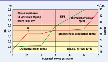
Оборудование БЭНЗ эксплуатируется в широком диапазоне подач и содержания мехпримесей
