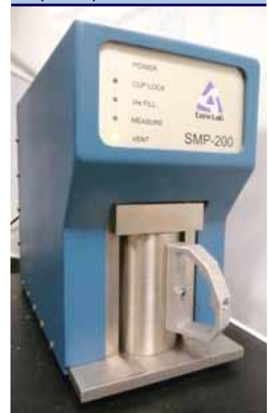
Рис.2 Сланцевый матричный пермеаметр SMP-200
